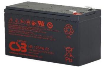
HR 1251W - батарея с высокой энергоемкостью. Особенная кристаллическая решетка электродов позволила увеличить на 20% отдаваемую мощность по сравнению с батареями других серий. Она разработана для эксплуатации в режиме высоких токов разряда при коротком времени разряда. Срок службы более 5 лет в буферном режиме или более 260 циклов заряда-разряда в циклическом режиме при 100% разряде.
