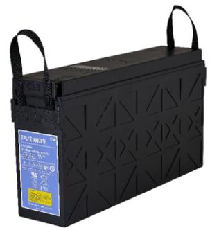
TPL121600FR - батарея с фронтальным расположением клемм и сроком службы 15 лет в буферном режиме при +20°C. В основном используется в качестве резервного питания в системах телекоммуникации и связи. Как и все батареи CSB, она перезаряжаемая, высокоэффективная и не требующая обслуживания.
