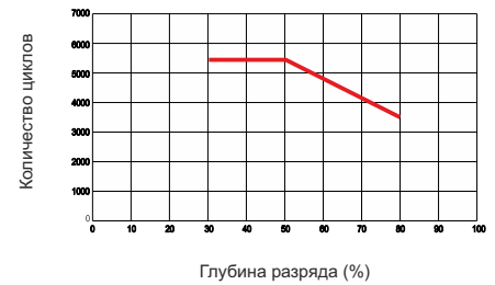
Зависимость циклов от глубины разряда
